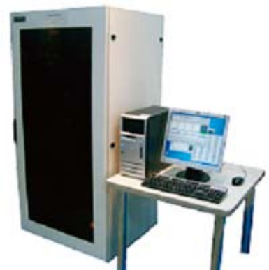
一度に100検体を全自動で検査できる 大量処理型細菌検査機器
